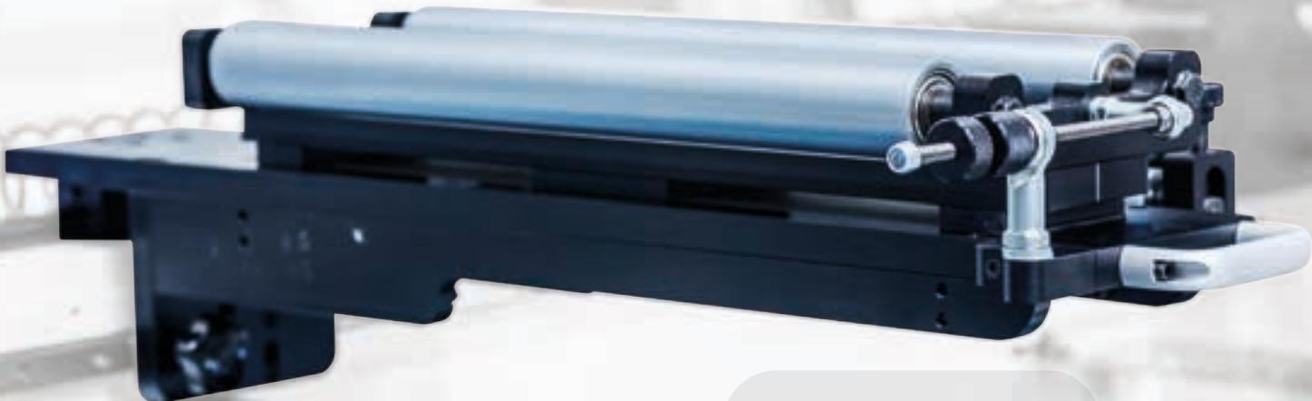
UNIT THAT ALLOWS THE **SEPARATION** OF ADHESIVE PAPER FROM THE SILICONATE SO THAT IT'S PRINTED ON THE GLUE SIDE AND THEN **RE-COUPLED**.
