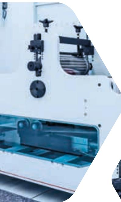
● Unità di fustellatura dotata dell'innovativo sistema a recupero di carta tramite un carrello lineare che permette l'utilizzo di un solo cilindro magnetico per tutti i formati di stampa per un facile e rapido cambio di lavoro.
